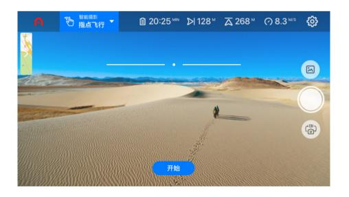
• 无人机会飞向选择的目标,遇到障碍物将会尝试绕过。您可以在飞行过程中点按页面上的其他点来更改飞行方向。若要更改飞行速度,通过页面中下方速度条进行调节。
