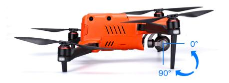
可使用两种方法中的一种调整云台 角度。相机云台将随之转动,如下 图所示。
