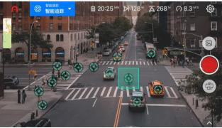
将自动开始3秒倒计时。追踪成功开始后,目标将被绿色的长方形框框起。
